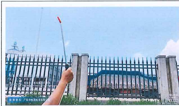
无组织废气下风向监控点 3#
